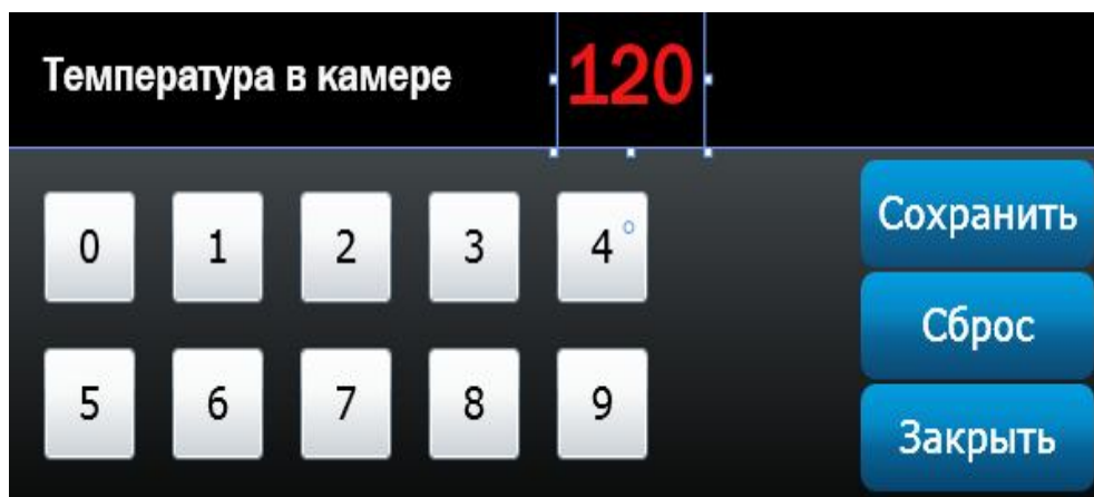
Рис. 9. Экран редактирования параметра «Температура в духовке»
