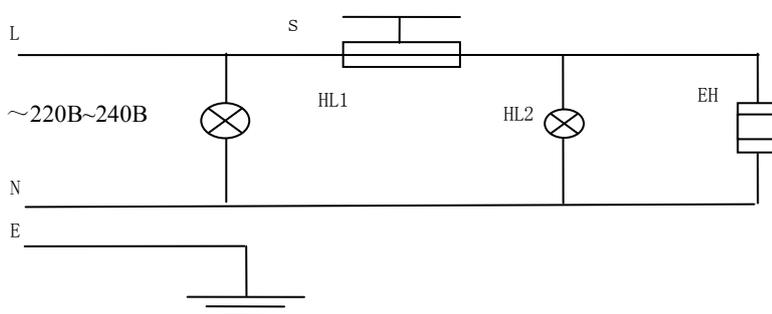
S— РЕГУЛЯТОР ТЕМПЕРАТУРЫ      EH— НАГРЕВАТЕЛЬНАЯ ТРУБКА
